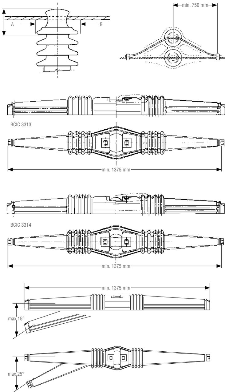
Durch ihre hohe Flexibilität passt sich die Vogelschutzhaube BCIC an unterschiedliche Kopfarmaturen und Seilanordnungen an und eignet sich für folgende Isolatorabmessungen:
