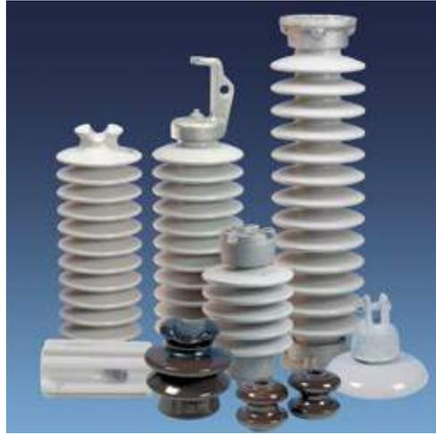
**Hybrid - Isolatoren** bestehen aus einem hochfesten Porzellanstab, der von einem Kunststoffgehäuse umgeben wird. Dieser Isolatortyp bietet eine sehr hohe mechanische Festigkeit und ein ausgezeichnetes elektrisches Verhalten in Gebieten mit sehr starker Verschmutzung. Die sehr guten Isolationseigenschaften unter Verschmutzung sowie die niedrigen Ableitströme führen zu einem wirtschaftlichen Einsatz des Isolators
