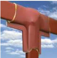
An T-Abzweigen und rechtwinkligen Abgängen wird die in zwei Richtungen schrumpfende, kleberbeschichtete Folie HVIS eingesetzt. Diese überlappt an den Enden die zuvor mit BBIT oder BPTM isolierte Schiene. Bei Erwärmung mit einem handelsüblichen Propangasbrenner schrumpft diese, verklebt und dichtet mit unterschiedlichen Dichtmitteln die Verbindungsstelle formschlüssig und dauerhaft ab
