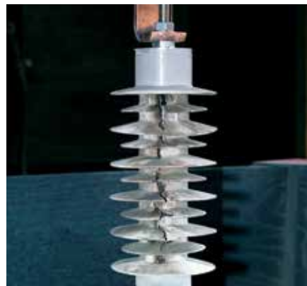
Sicherer Ausfall bei Kurzschluss
