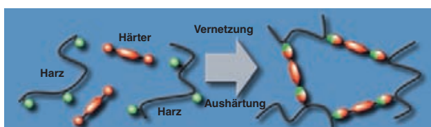
Bild 1 Schematische Darstellung der Reaktion bei Polyurethanen
