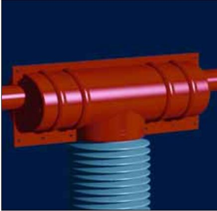
**Klapphaube zur Isolation von Übergängen an Stützisolatoren**
