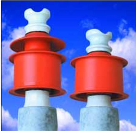
Hybrid-Isolatoren bestehen aus einem hochfesten Porzellanstab, der von einem Kunststoffgehäuse umgeben wird. Dieser Isolatortyp bietet eine hohe mechanische Festigkeit und ein ausgezeichnetes elektrisches Verhalten in Gebieten mit starker Verschmutzung, z.B. bei extremen klimatischen Bedingungen, wie in Tropen- und Wüstengebieten. Die guten Isolationseigenschaften unter Verschmutzung sowie die niedrigen Ableitströme führen zu einem wirtschaftlichen Einsatz des Isolators.
