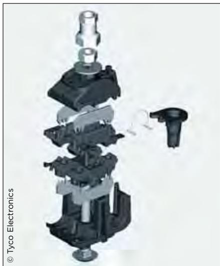
Vollisolierte Klemmen aus hochfestem glasfaserverstärktem Kunststoff mit eingepressten Kontaktzähnen für die Montage unter Spannung. Beim Anziehen der Schraube durchdringen die Kontaktzähne die Isolation und stellen den Kontakt auf dem Leiter her. Ein Abisolieren des Leiters ist nicht erforderlich. Die Schrauben sind drehmomentgesteuert und reißen bei dem jeweiligen fest definierten Anzugsdrehmoment ab.
