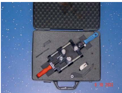
Semicon Abisolier- und Isolierungsschneidwerkzeug
