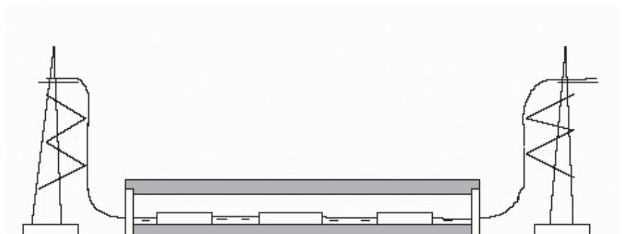
Kabelverlegung und Verbindung in einem Betonkabelkanal.
