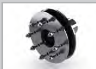
Futterrohr mit Fest-/Losflanschkonstruktion Zur Abdichtung von Dichtbahnen (schwarze Wanne) nach DIN 18 195 Teil 9. Ausführung in Edelstahl. Innendurchmesser: 60–2.000 mm
