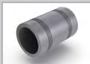
Futterrohr aus Faserzement Mit Labyrinth-Ringen. Material asbestfrei. Innendurchmesser: 80–1.500 mm
