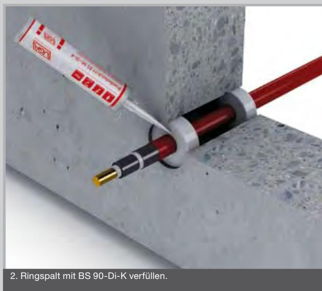
2. Ringspalt mit BS 90-Di-K verfüllen.
